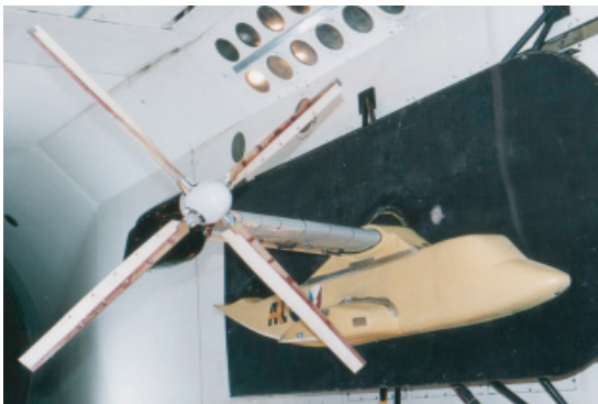
Fig. 2 WRATS SASIP in the NASA TDT
